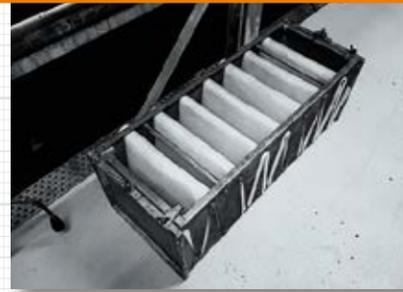
Umständlicher und zeitraubender Filterwechsel bisher: Das Vlies musste händisch in den Stahlkasten eingefaltet und befestigt werden.
