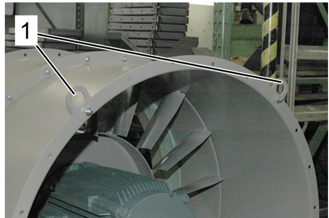
Abb. 19: Axialventilator mit Transportösen
