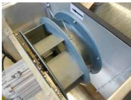
Ventilator mit EC-Antriebsmotor
